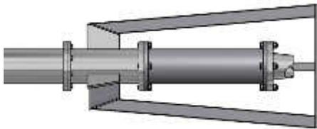
**Modularité :** La série Diamant se base sur le concept de modularité pour chacun de ses composants : parties hydrauliques, tubages, joints, socles, supports, arbres de transmission. Chaque composant peut être réalisé dans une série de variantes sans modifier la structure de la machine et en maintenant le standard des principales pièces de rechange.
